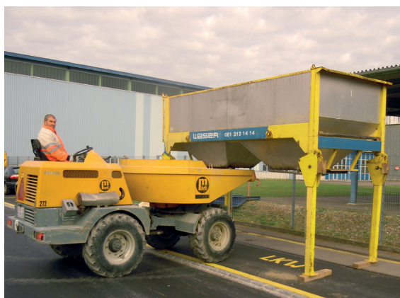
WARMHALTESILO: Unterfahrhöhe 1,6 Meter ab Boden Nutzlast 10 Tonnen (2 Kammern à 5 Tonnen)
