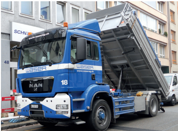
2-ACHS THERMOSILO: 2 Kammern Nutzlast 7 Tonnen
