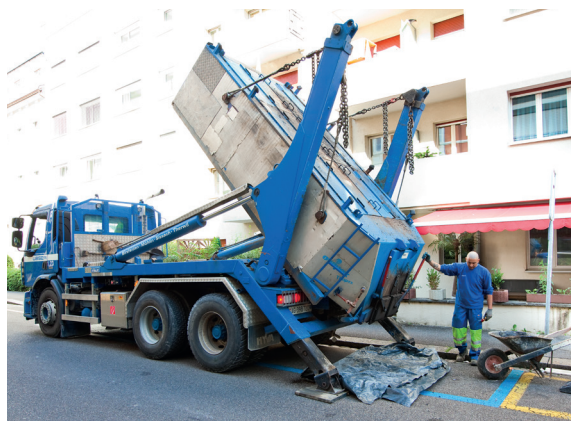
3-ACHS THERMOSILO: 2 Kammern Nutzlast 10 Tonnen
