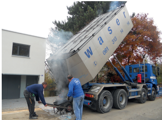
4-ACHS THERMOSILO: 2 Kammern Nutzlast 16 Tonnen
